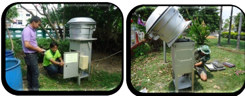
รูปที่ ๑.๒๗-๑.๒๘ แสดงการตรวจสอบปริมาณฝุ่นละอองขนาดไม่เกิน ๑๐ ไมครอน (PM-๑๐) โดยใช้เครื่องมือเก็บตัวอย่างอากาศ High Volume Air Sampler
